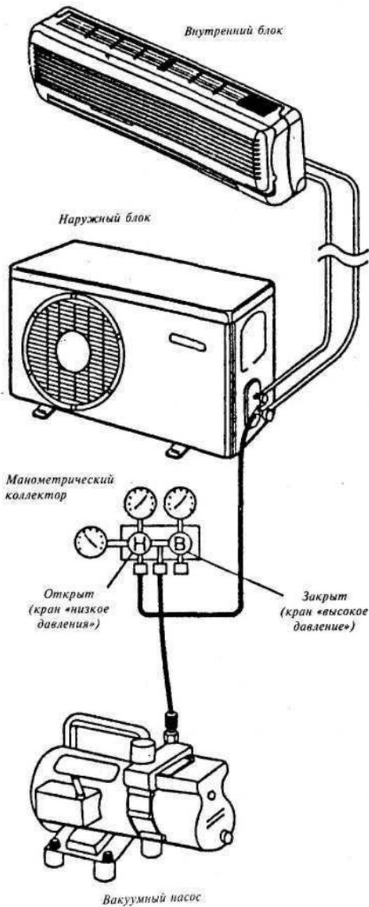
Рис. 14. Вакуумирование контура циркуляции хладагента
