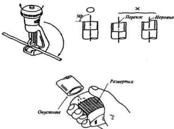
**Рис. 10. Резка медного трубопровода**
