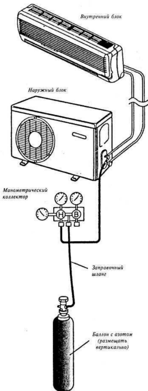
Рис. 13. Опрессовка контура циркуляции хладагента
