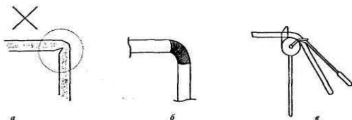
**Рис. 12. Выполнение сгиба трубки:**
