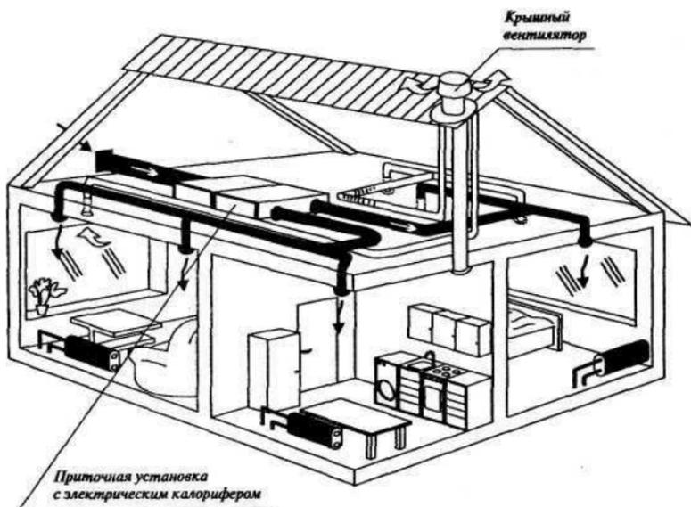
**Рис. 1. Система приточно-вытяжной вентиляции
