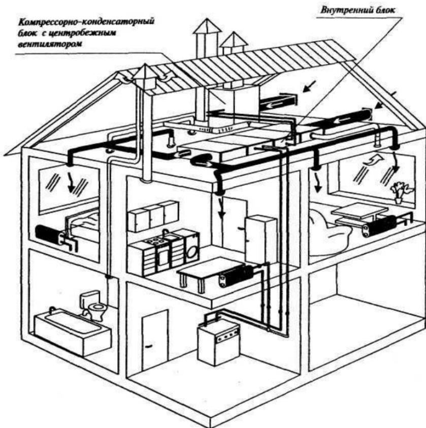
Рис. 3. Система кондиционирования воздуха коттеджа
