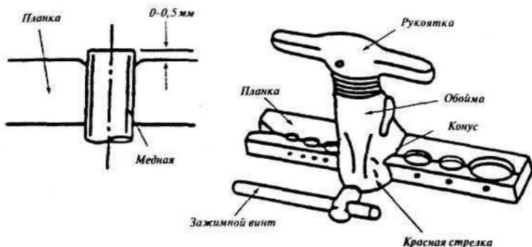
**Рис. 11. Развальцовка медного трубопровода**
