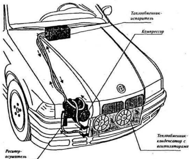
**Рис. 5. Основные элементы автомобильной климатической системы**
