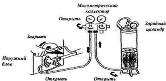
**Рис. 15. Заправка контура хладагентом из зарядного цилиндра**
