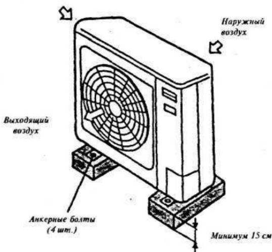
**Рис. 8. Размещение наружного блока на опорах**
