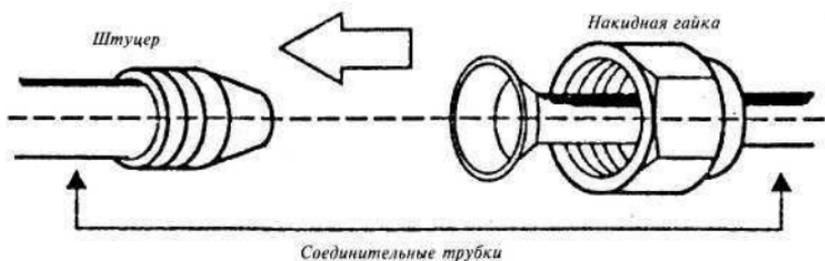
Рис. 9. Стыковка медных соединительных трубок
