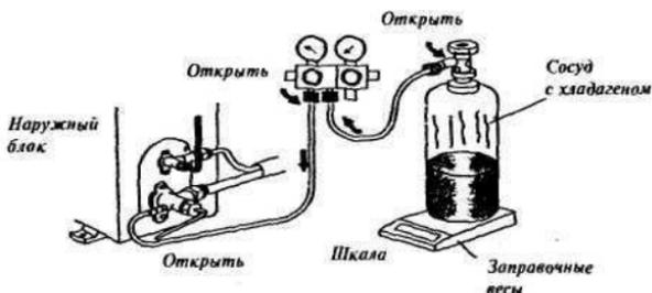
**Рис. 16. Заправка с использованием заправочных весов**
