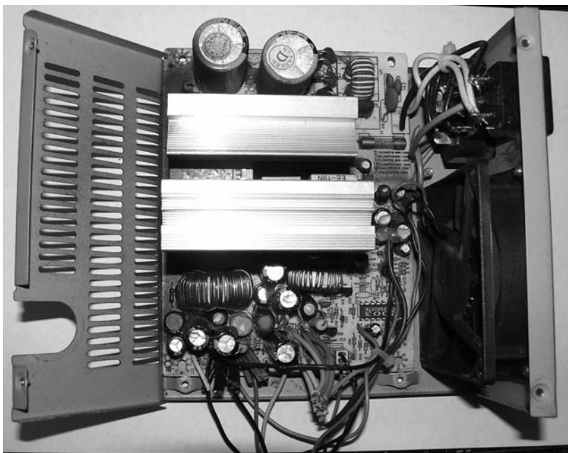
Рис. 5.2. Вид на БП ПК LC-B250 АТХ со снятой крышкой корпуса
